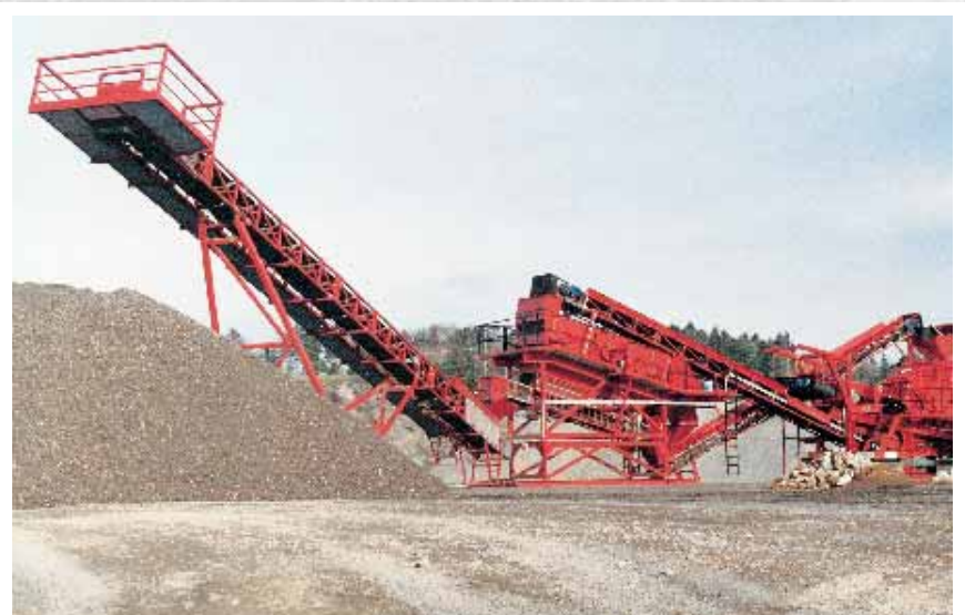
Beispiel 2: FMS Förderbandwaage in einer Strassenabbruch-Aufbereitungsanlage. Kapazität 50 t/h
